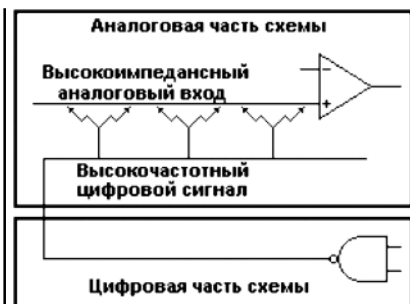
Рисунок 3 Излучение проводниками печатной платы
